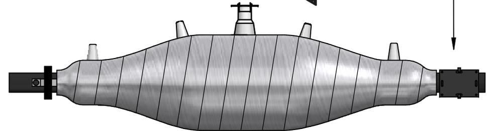
En jonction : Placer la plaque signalétique sur le câble au plus près de l'accessoire (à environ 10 mm du ruban adhésif d'étanchéité).
